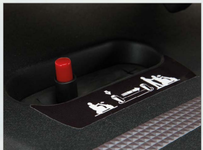
De twee-staps motorontkoppelingshendel voorkomt onbedoeld wegvallen van de aandrijving.
