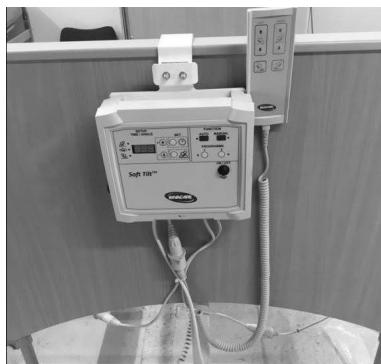
Verzamel de motorkabels in een bundel en maak deze vast met een tie-wrap. Schuif het bed heen en weer om te zorgen dat de bundel niet blijft haken achter bedonderdelen en dat deze vrij kan bewegen.
