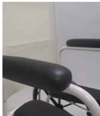
Armluning naar buitenzijde geplaatst
